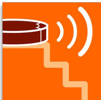
Lorsqu'il se déplace dans votre maison, les capteurs infrarouges situés sous le robot l'empêchent de tomber en cas de dénivelé. Il se déplace de manière autonome en évitant les escaliers et les bords.
