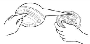
3. Afin de démarrer le chargement manuel utiliser la télécommande. Le robot aspirateur se mettra automatiquement à la recherche de la station de charge.
