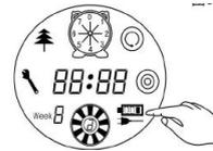
5. Lorsque la batterie est épuisée l'icône se met à clignoter sur l'écran du robot aspirateur. Afin d'informer que l'appareil est en train de charger les barres qui se trouvent à l'intérieur de l'icône "pile" se mettent à clignoter les unes après les autres. L'icône s'arrête de clignoter lorsque l'appareil est totalement chargé.
