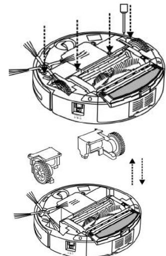
3. Remplacez les roues à leur emplacement initial et serrez les vis.
