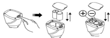
Remplacement des piles de la télécommande :
