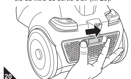
3. Retirez le filtre de sortie d'air.
