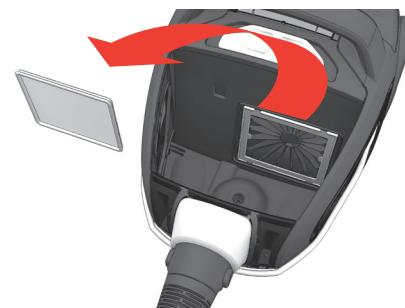
Tire de la sujeción y extraiga el contorno del filtro. Extraiga el filtro y límpielo. Vuelva a montar el soporte del filtro colocándolo en la parte inferior. A continuación, sitúe el contorno encima.
