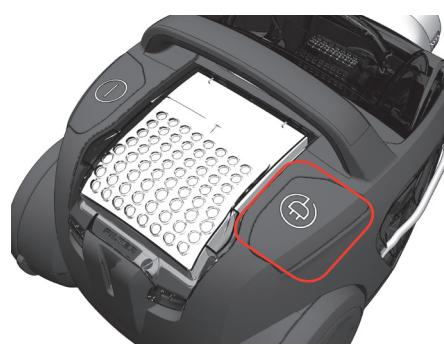
Imuroinnin jälkeen **virtajohto** kelataan sisään painamalla KELAUS-painiketta.
