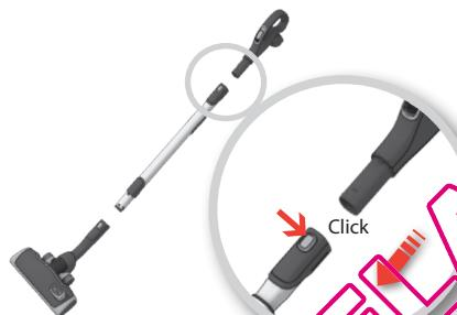
Acople el tubo telescopico al asa del tubo (para retirarlo, pulse el botón de bloqueo y tire del asa hacia afuera).
