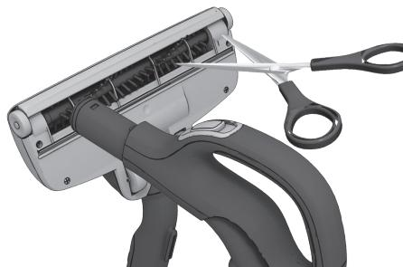
Maak het mondstuk los van de zuigbuis en verwijder alle vastzittende draden, enz., door ze met een schaar los te knippen. Gebruik de slanggreep om het mondstuk te reinigen.
