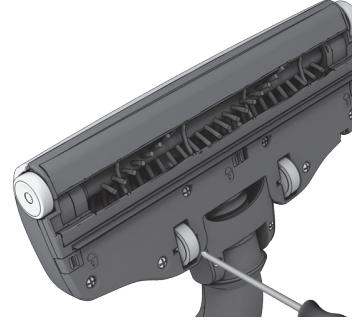
Если колеса застряли, осторожно снимите их небольшой отверткой.
