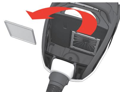
Trek aan het handvat en verwijder het filterframe. Verwijder/reinig het filter. Monteer het frame weer in de filterhouder door het frame onderin de houder te zetten en bovenin de houder op zijn plaats te drukken.
