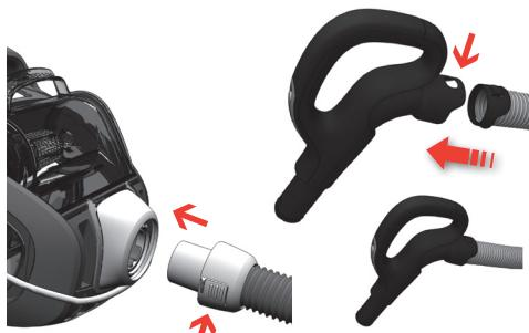
Вставьте шланг (чтобы снять шланг, нажмите кнопки-фиксаторы и вытяните его).
