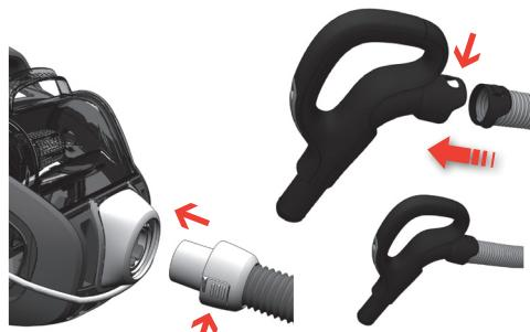
Inserte el tubo flexible (para retirarlo, pulse los botones de bloqueo y tire del tubo hacia afuera).
