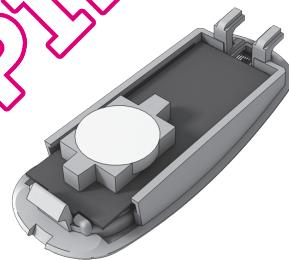
Gebruik alleen batterijen van het type LITHIUM CR2032. Voordat u het apparaat wegdoet, moet u de batterijen eruit halen en deze op verantwoorde wijze afvoeren.
