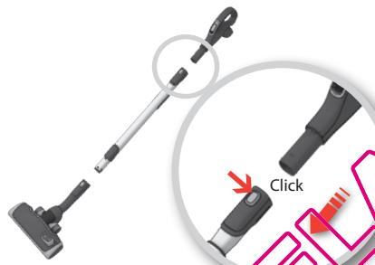
Collegare il tubo telescopico all'impugnatura del tubo flessibile (per rimuoverlo, premere il pulsante di rilascio ed estrarre il tubo flessibile).
