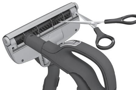
Αποσυνδέστε το ακροφύσιο από το σωλήνα της ηλεκτρικής σκούπας και αφαιρέστε τις μπλεγμένες κλωστές κ.λπ. κόβοντάς τις με ψαλίδι. Χρησιμοποιήστε τη χειρολαβή του εύκαμπτου σωλήνα, για να καθαρίσετε το ακροφύσιο.
