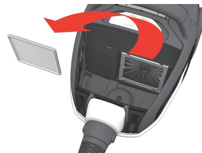
Τραβήξτε το χερούλι και αφαιρέστε το πλαίσιο φίλτρου.
