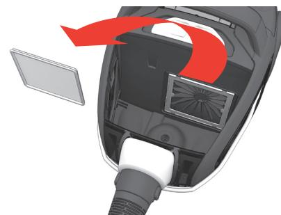
Tirare il dispositivo di tenuta e rimuovere il telaio del filtro.
