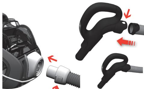
**Bevestig de slang** (om deze weer te verwijderen, drukt u op de ontgrendelknoppen en trekt u de slang los).
