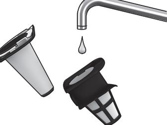
4b. Ločite filtra. Zbiralnik za prah in filtra lahko otresete ali pa jih splaknete s toplo vodo (*nikoli jih ne perite v pomivalnem stroju*). Preden dele znova namestite in nasprotnem vrstnem redu, jih dobro osušite.
