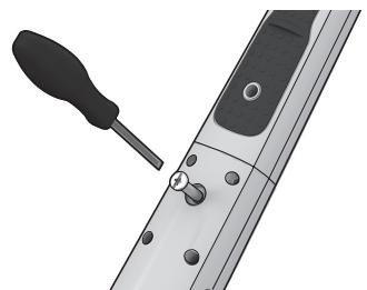
2. Фиксирайте дръжката със затягане на приложения стопорен винт. Използвайте отвертка или монета.
