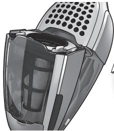
3. Hitro čiščenje filtra za drobne delce (priporočljivo ob vsakem čiščenju). Odstranite zbiralnik za prah, pet- ali šestkrat povlecite in spustite vzmet, da odstranite prah.
