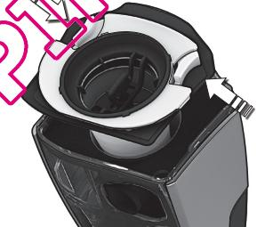
4a. Reinigen von Staubbehälter und Filtern. (Bei jedem 5. Reinigen empfohlen). Staubbehälter abnehmen, beide Filter durch Drücken der Freigabeknöpfe herausnehmen.
