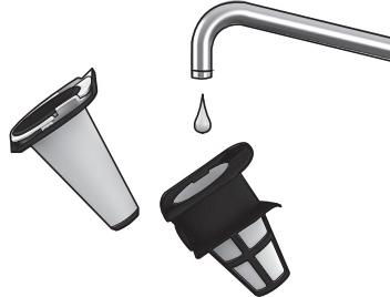
4b. Отделите фильтры. Пылесборник и фильтры для очистки можно потрясти или промыть теплой водой (ни в коем случае не в посудомоечной машине). Перед тем как поместить на место, все детали следует просушить.
