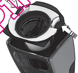
4a. Очистка пылесборника и фильтров. (Рекомендуется при каждой 5-й чистке.) Снимите пылесборник и выньте оба фильтра, нажав на кнопки-фиксаторы.
