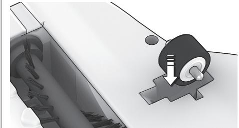
**3. Rimuovere gli oggetti eventualmente rimasti incastrati nei perni delle ruote.** Rimontare le ruote premendole negli appositi binari.
