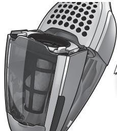
3. Быстрая очистка тонкого фильтра. (Рекомендуется при каждой чистке.) Снимите пылесборник и сожмите пружину 5-6 раз, чтобы выбить пыль.
