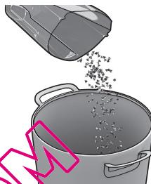
**2. Dulkių surinktuvo ištušinimas.** Išimkite filtres, jų turinį išplikite į šiuksliadėžę. Vėl įdėkite filtres ir atgaiciuokite dulkių surinktuvą.
