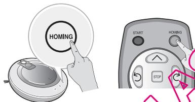
Méthode 2. Si vous appuyez sur la touche 'HOMING' de la télécommande ou le bouton 'HOMING' de l'aspirateur robot, le chargement démarrera par un retour automatique de l'aspirateur robot vers la base de chargement avec la voie de recherche.
