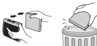
Retirez et remplacez le filtre de sortie bouché.
